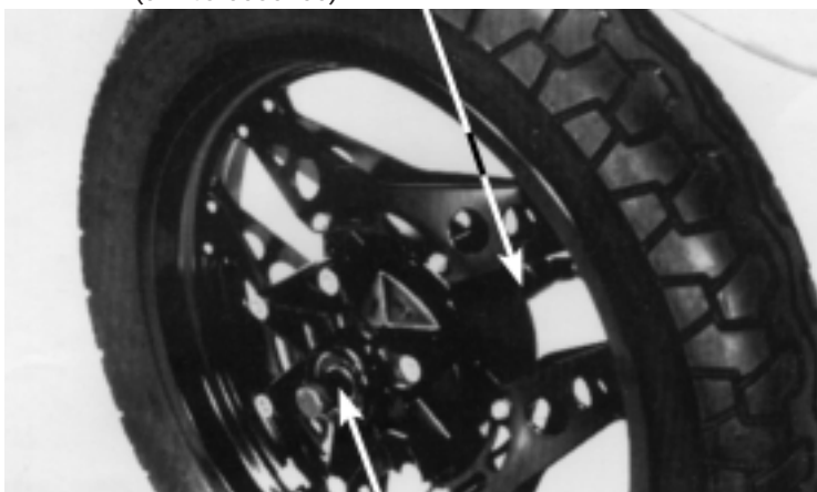
CABEÇOTE DO EXTRATOR DE ROLAMENTOS, 20 mm (07746-0050600)
