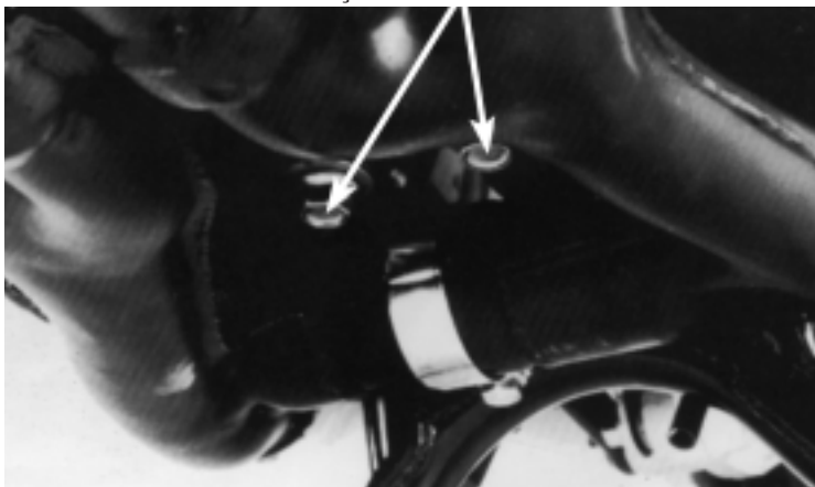
PARAFUSOS DE FIXAÇÃO NO MOTOR DA CÂMARA DE COMPENSAÇÃO DO ESCAPAMENTO
